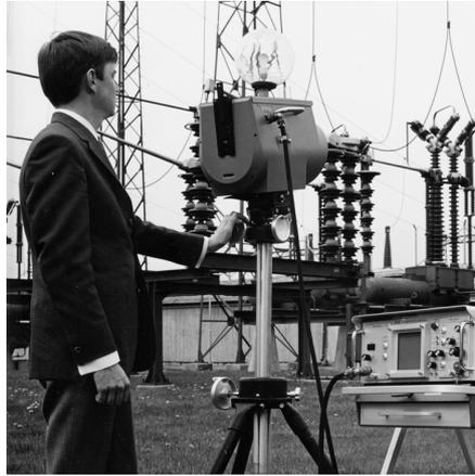
그림 30.2 1969년: Thermovision 모델 661. 카메라 무게는 약 25kg, 오실로스코프는 20kg, 삼각대는 15kg입니다. 220VAC 발전기 세트와 액체 질소가 들어있는 10L 용기도 필요합니다. 오실로스코프 왼쪽에 폴라로이드 부착물(6kg)을 볼 수 있습니다.
