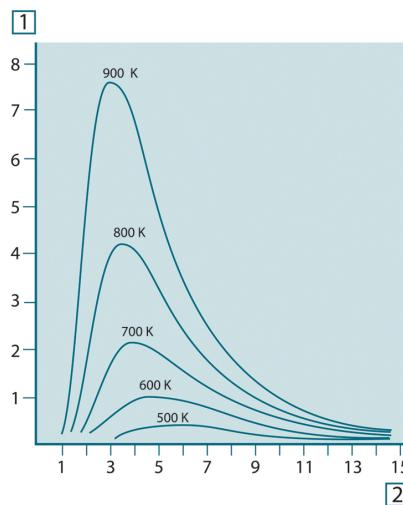
그림 35.4 플랑크 복사 공식에 따르면 흑체 분광 복사 에너지 방출량은 다양한 절대 온도에 따라 점으로 표시됩니다. 1: 분광 방출 스펙트럼( $\text{W}/\text{cm}^2 \times 10^3(\mu\text{m})$ ); 2: 파장( $\mu\text{m}$ )
