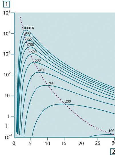
그림 35.6 폴랑크 곡선은 모든 종이 간격으로 100 K에서 1000 K까지 점으로 곡선을 그립니다. 점선은 Wien의 법칙에 의해 설명된 것처럼 각 온도에 최대 복사 에너지 방출량의 규칙을 나타냅니다. 1: 분광 복사 에너지 방출량( $\text{W}/\text{cm}^2 (\mu\text{m})$ ); 2: 파장( $\mu\text{m}$ )
