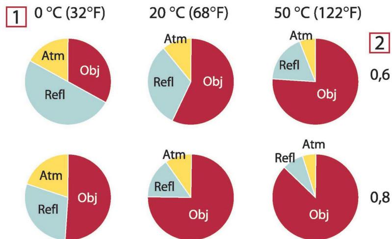
그림 36.2 다양한 측정 조건 하에서 방사원의 상대적 중요도(SW 카메라). 1: 물체 온도; 2: 방출량; Obj: 물체 방사; Refl: 반사된 방사; Atm: 대기 방사. 고정 매개변수:  $\tau = 0.88$ ;  $T_{refl} = 20^{\circ}\text{C}$ ;  $T_{atm} = 20^{\circ}\text{C}$ .
