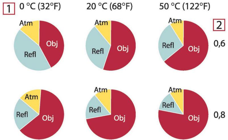
그림 36.3 다양한 측정 조건 하에서 방사원의 상대적 중요도(LW 카메라). 1: 물체 온도; 2: 방출량; Obj: 물체 방사; Refl: 반사된 방사; Atm: 대기 방사. 고정 매개변수:  $\tau = 0.88$ ;  $T_{\text{refl}} = 20^\circ\text{C}$ ;  $T_{\text{atm}} = 20^\circ\text{C}$ .
